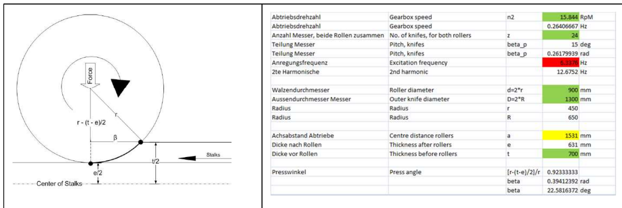
Bild 11 Berechnung der anregenden Frequenz und Abschätzung der Lastüberhöhung in Funktion der Anzahl Messer.
