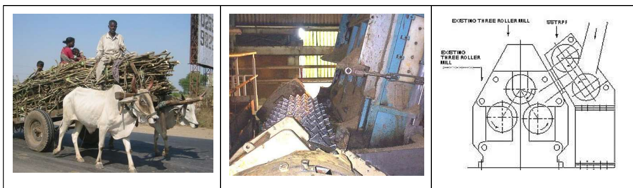
Bild 2 Links: Transport des Zuckerrohres. Mitte: Zuführung zum Schredder. Rechts: Schredder mit zwei Rollen, gefolgt von der Presse mit drei Rollen.
