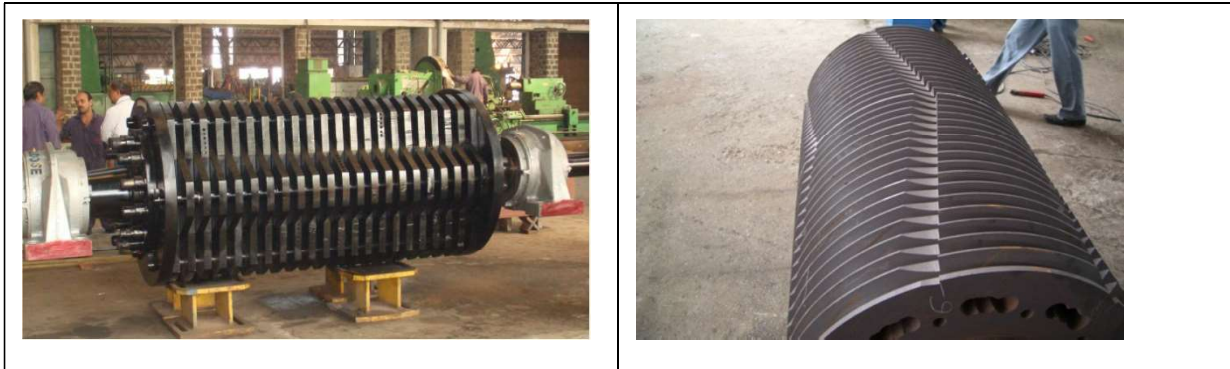
Bild 3 Oben: Schredder Rollen unterschiedlicher Konstruktion und mit unterschiedlicher Anzahl Messer.
